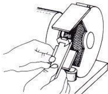
Rys. 42. Ostrzenie noża na ostrzarce elektrycznej [6, s. 176]
