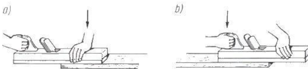
Rys. 48. Sposób ujęcia i prowadzenie spustu: a) początek posuwu, b) końcowa faza posuwu [5, s. 306]
