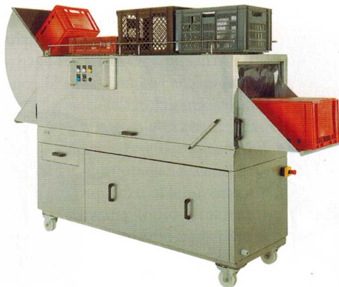
Ryc. 3.21. System czyszczenia pojemników
