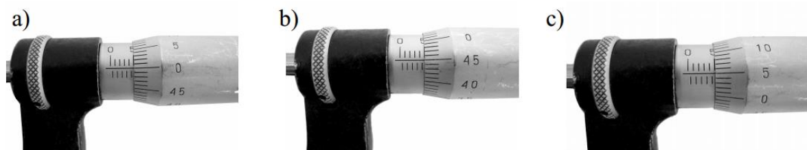
Rys. 1.55. Prawidłowe wskazazy na bębnie mikrometru: a) wymiar 5,00 mm, b) wymiar 4,95 mm (5-0,05) c) wymiar 5,05 mm (5+0,05)
