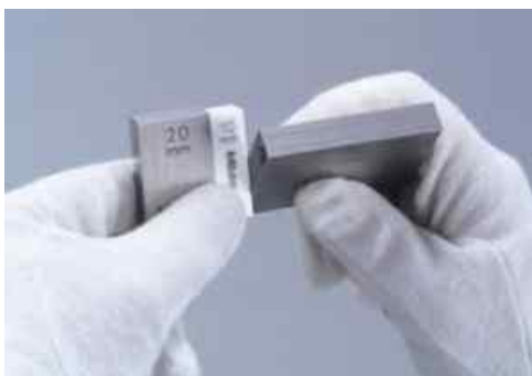
Rys. 1.5. Sposób składania stosu płytek wzorcowych
