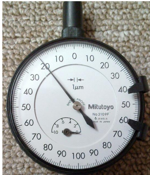
Rys. 1.57. Odczyt wskazania czujnika zegarowego
