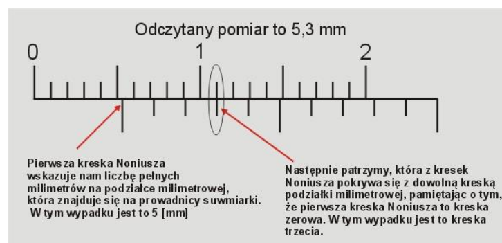
Rys. 1.21. Sposób odczytu wartości zmierzonej na noniuszu
