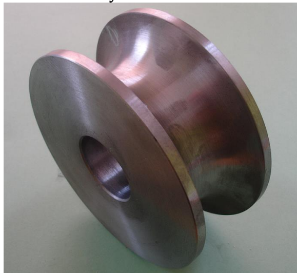
Rys. nr 6.48. Rolka wykonane w toczeniu kształtowym
