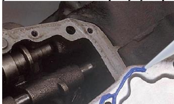
Rys. nr 6.37. Uszczelnianie pokryw korpusu
