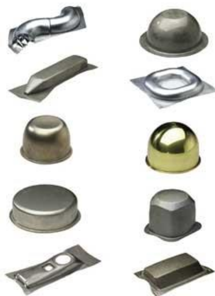
Rys. nr 6.20. Elementy wykonane w procesie tłoczenia
