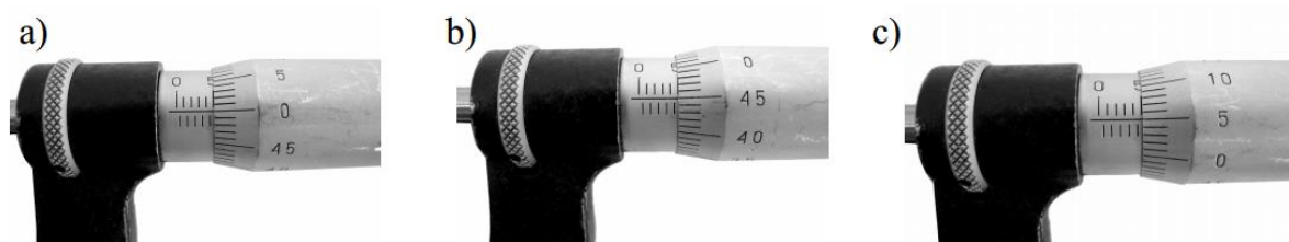
Rys. 1.55. Prawidłowe wskazazy na bębnie mikrometru: a) wymiar 5,00 mm, b) wymiar 4,95 mm (5-0,05) c) wymiar 5,05 mm (5+0,05)
