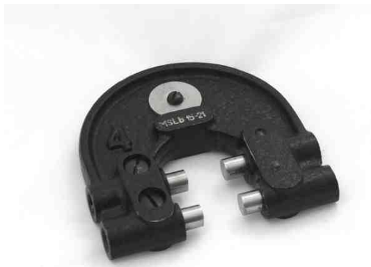
Rys. 1.45. Sprawdzian szczękowy dwustronnie nastawny
