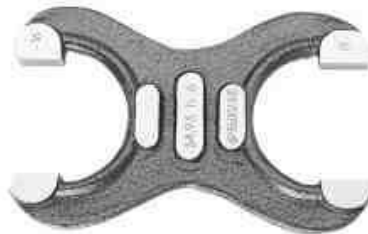
Rys. 1.43. Sprawdzian dwugraniczny do wałków
