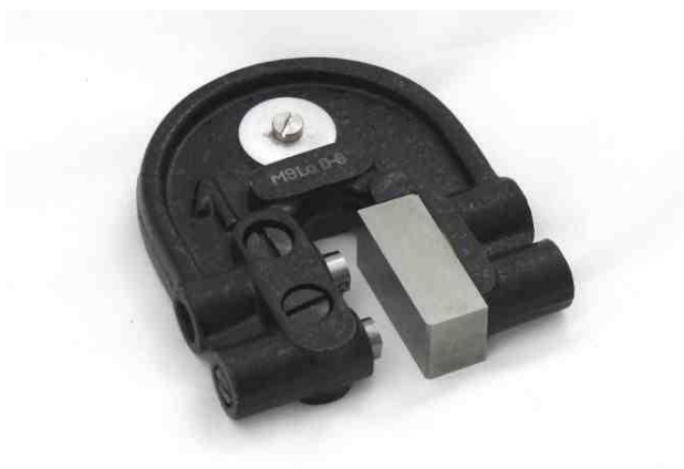
Rys. 1.44. Sprawdzian szczękowy jednostronnie nastawny
