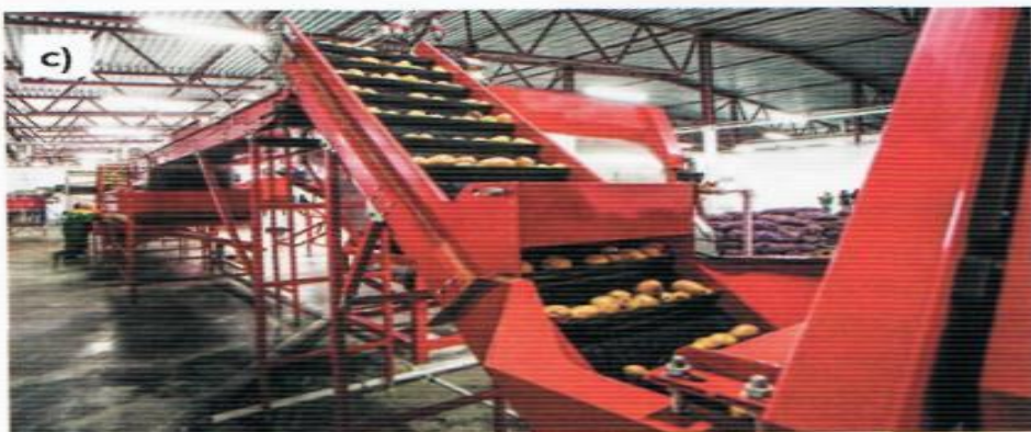
Ryc. 9.19. Przenośniki ciągnowe: a) taśmowy, b) zgarniakowy c) czerpakowy
