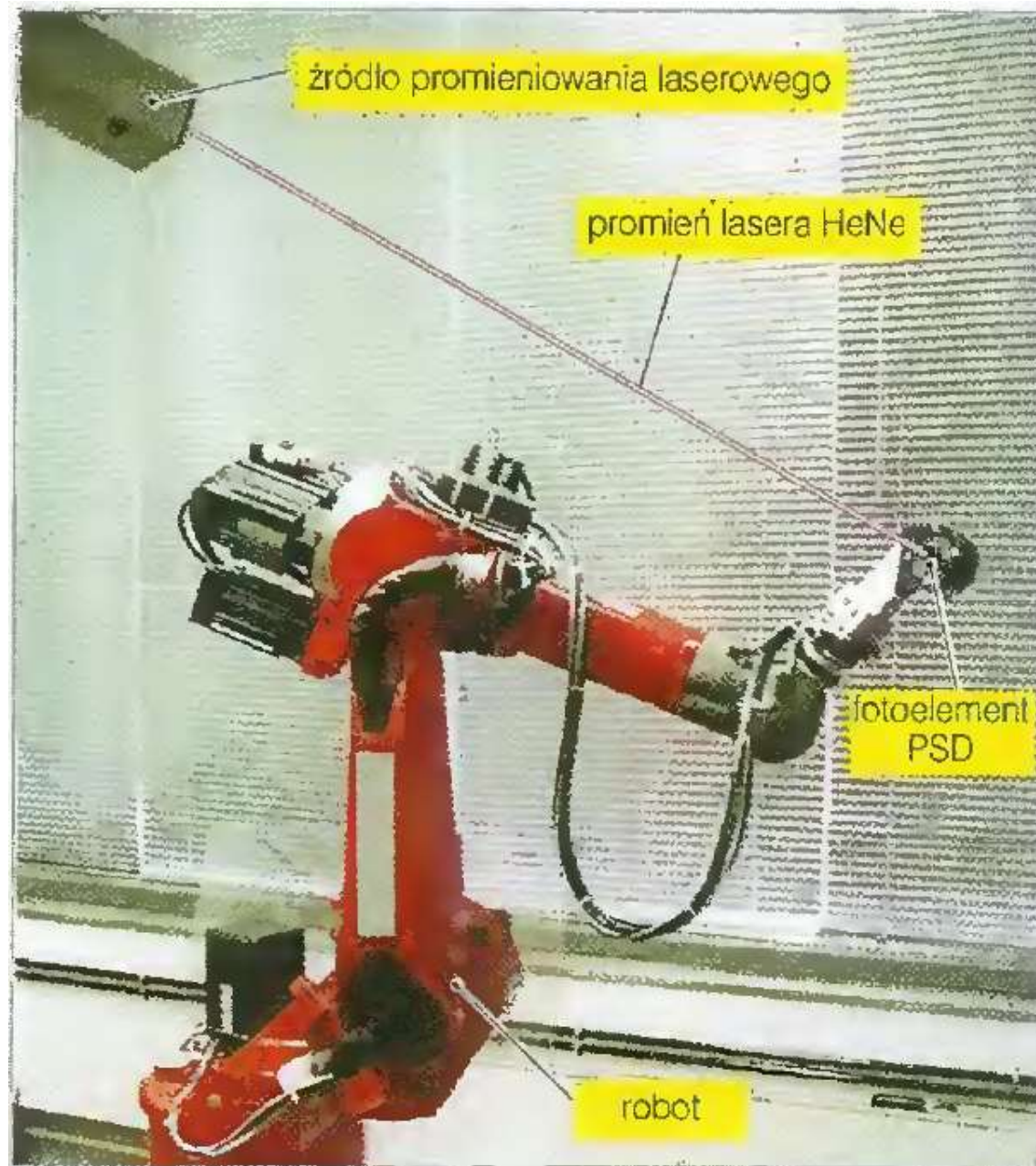
Rys. 3. Wyznaczanie dokładności ruchu robota wzdłuż linii prostej za pomocą fotoelementu PSD
