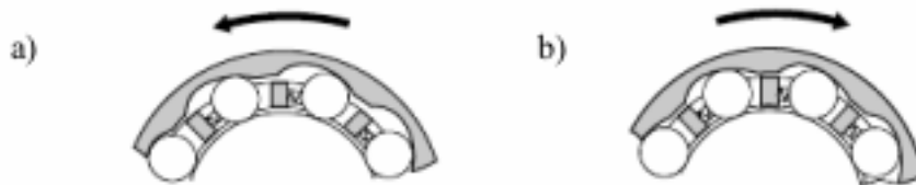
Rys. 17. Sprzęgło jednokierunkowe: a) elementy zasprężone, b) elementy rozsprężone.
