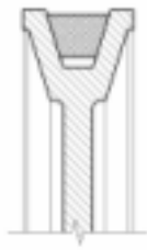
Rys. 38. Koło pasowe przekładni pasowej współpracujące z paskiem klinowym
