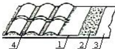
Rys. 27. Tworzywo skóropodobne typu seal-tuft 1 – barwna folia kryjąca, 2 – środkowa warstwa, 3 – warstwa spodnia, 4 – zgrzewanie punktowe [5, s. 100]
