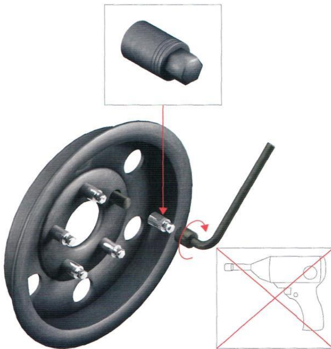
Rys. 1.6. Rysunek instrukcyjny przykręcania śruby zabezpieczającej koła
