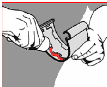
Rys. 55. Sposób nakładania kleju na złączkę rynny [folder producenta]
