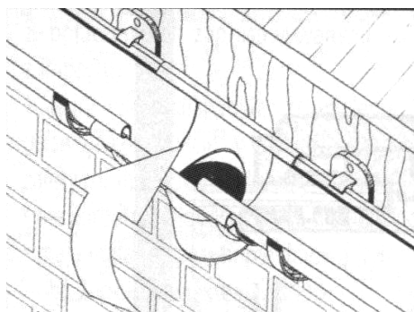
Rys. 40. Założenie leja spustowego [folder producenta]
