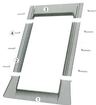
Rys. 27. Kołnierz do pokryć płaskich: 1) element dolny, 2) element boczny, 3) element dolny 4) blaszki do mocowania kołnierza [6, s. 48].
