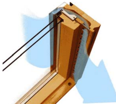
Rys. 2. Wentylacja pomieszczenia przez okno dachowe – zdjęcie [6, s. 16].
