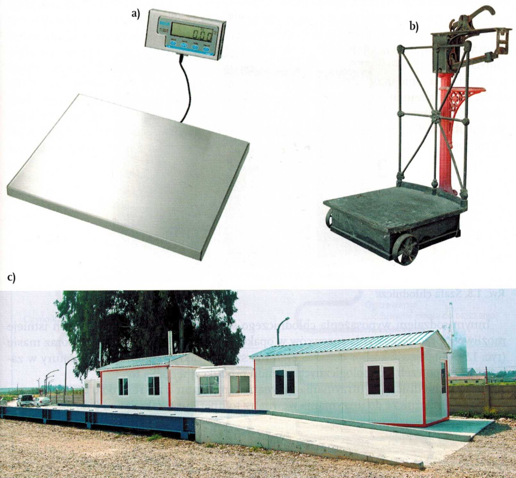
Ryc. 1.7. Wagi: pomostowe (a, c), przesuwnikowa (b)
