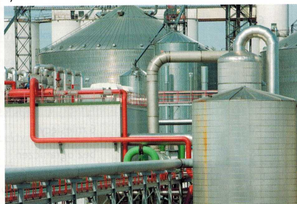
Ryc. 1.6. Zbiorniki na surowce: a) sypkie – silosy metalowe lub materiałowe, b) płynne – silosy wkomponowane w linię technologiczną lub niezależne
