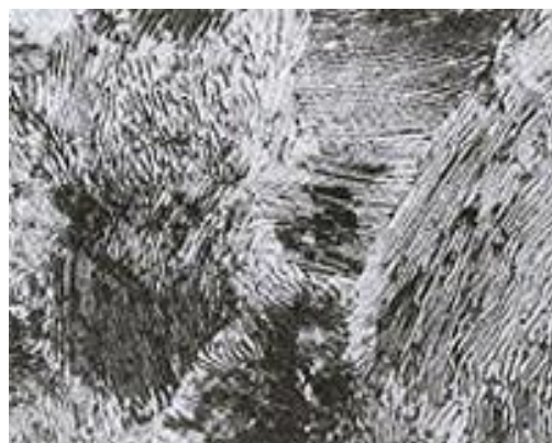
Rys. 7. Stal o zawartości ok. 0,8% C (pow. x 500). Perlit [2, s. 450]
