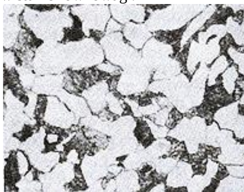
Rys. 6. Stal o zawartości ok. 0,35% C (pow. x 500). Perlit (ciemne ziarna) i ferryt (jasne ziarna) [2, s. 450]
