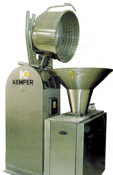
Ryc. 4.18. Wywrotnica do dzieży nad lejem spustowym dzielarki
