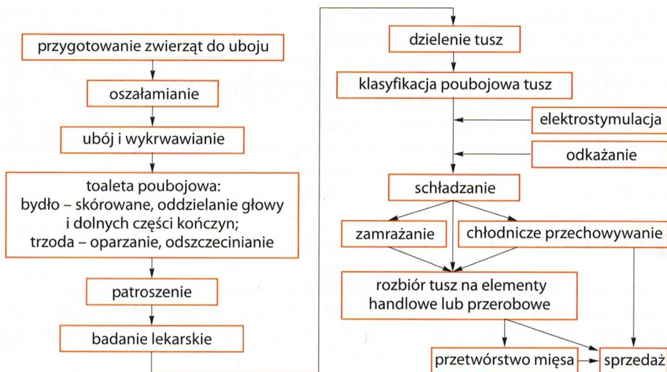
Ryc. 14.3. Schemat operacji technologicznych na linii uboju zwierząt rzeźnych
