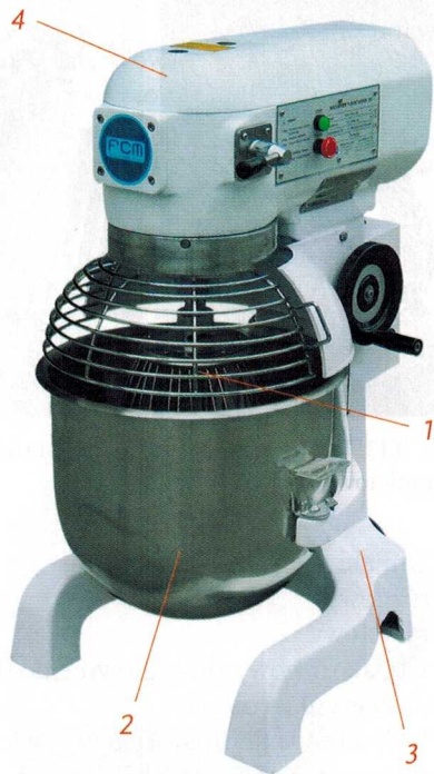
Ryc. 9.11. Mieszarka: 1 – mieszadło, 2 – dzieża, 3 – korpus, 4 – napęd elektryczny.
