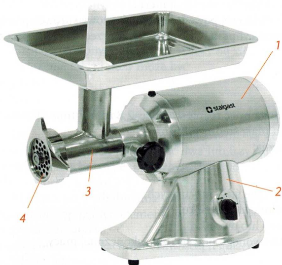
Ryc. 9.4. Budowa wilka: 1 – kadłub, 2 – zespół napędowy, 3 – zespół podający mięso, 4 – zespół tnący
