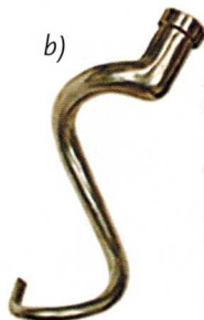
Ryc. 9.12. Różne kształty mieszadeł: a) łapowe, b) hakowe, c) różgowe
