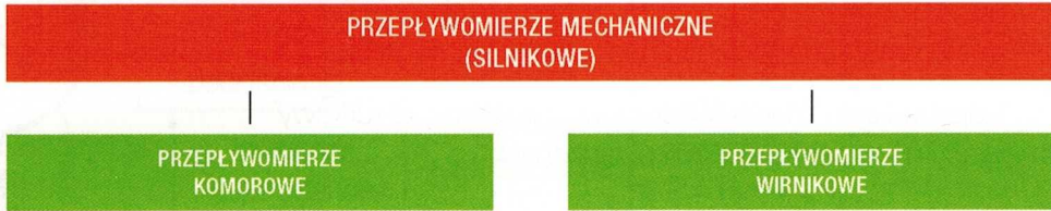
Rys. 4.5. Podział przepływomierzy mechanicznych (opracowanie własne)
