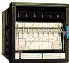
Rys. 4.20. Rodzaje rejestratorów: taśmowy i cyfrowy
