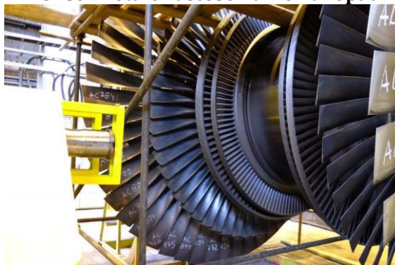
Rys. nr 1.23. Cermetale zastosowanie na łopatki turbin
