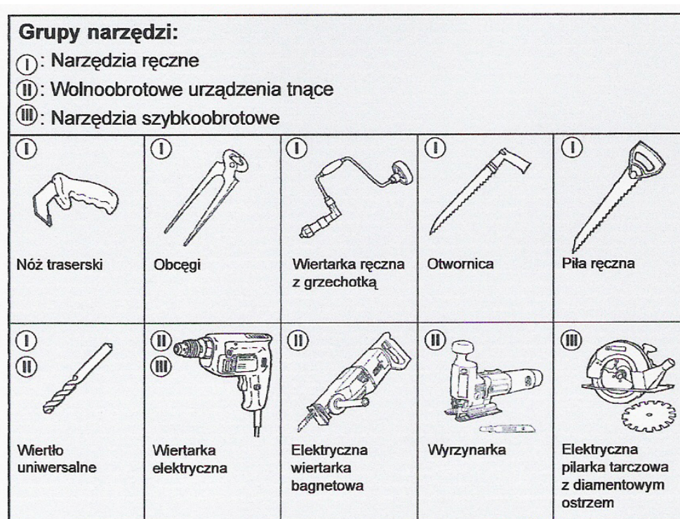
Rys.15. Narzędzia stosowane przy montażu płyt Eurofala [1, s.6]
