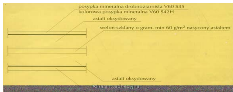
Rys. 8. Struktura papy zgrzewalnej [folder producenta]
