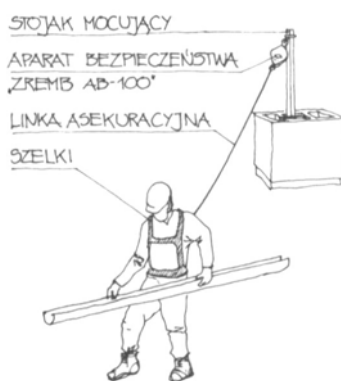
Rys. 2. Przykład zabezpieczenia dekarza przed upadkiem z dachu [5, s. 515]
