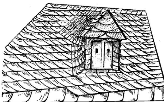
Rys. 17. Widok dachu łupkowego [14, s. 480]
