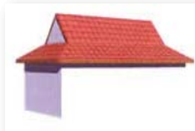
Rys. 13. Dach przyczółkowy [www.braas.pl].
