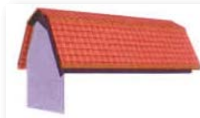
Rys. 15. Dach mansardowy [www.braas.pl].
