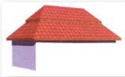
Rys. 12. Dach mansardowy polski [www.braas.pl].
