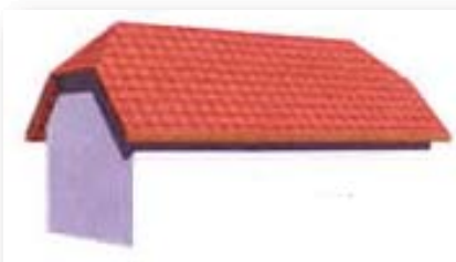
Rys. 14. Dach naczółkowy [www.braas.pl].
