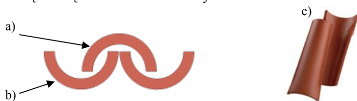
Zdjęcie 12. Dachówki mnich i mniszka: a) mnich, b) mniszka, c) układ dachówek [8, s. 69].
