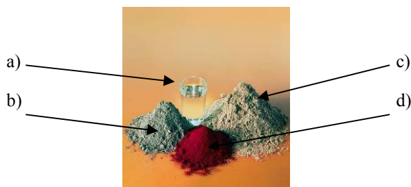
Zdjęcie 5. Składniki do produkcji dachówek cementowych: a) woda, b) cement, c) piasek, d) pigment [www.braas.pl].
