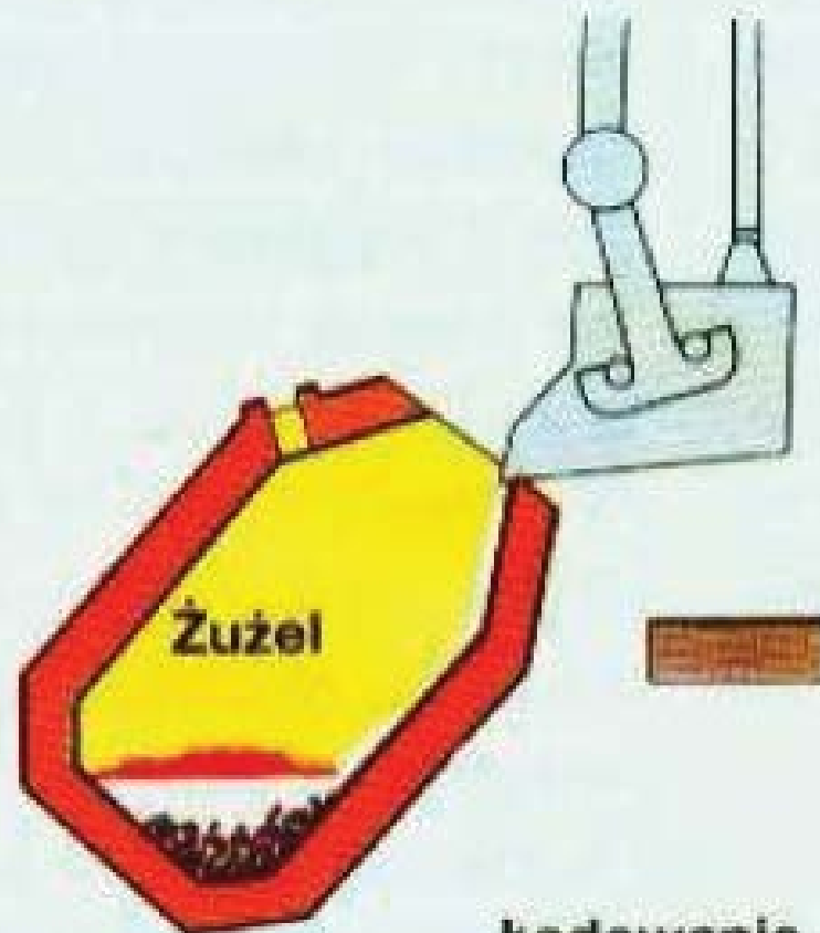
Ładowanie konwertora ciekłą surówką
