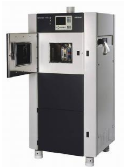
Rys. 25. Aparat Xenotest do badań starzeniowych z lampą ksenonową [21]
