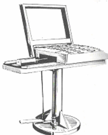
Rys. 26. Urządzenie pneumatyczne do mocowania stelaży w czasie tapicerowania [5,s 50]
