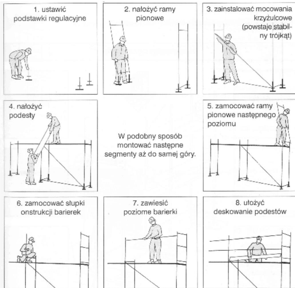
Rys.16. Montaż rusztowania ramowego [1, s. 39]
