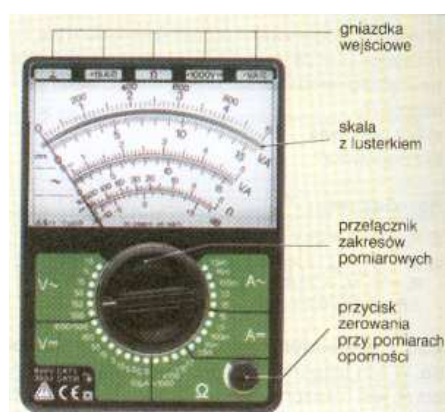
Rys. 24. Wskazówkowy miernik wielozakresowy [2, s. 168]
