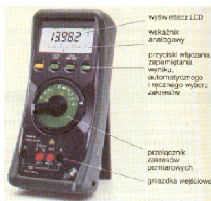
Rys. 25. Cyfrowy miernik wielozakresowy [2, s. 168]
