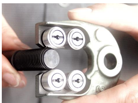
Rys. 6.22. Sprawdzanie średnicy podziałowej gwintu
