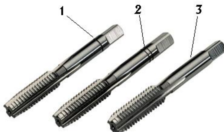
Rys. 6.19. Oznaczenie gwintowników w kompletach składających się z trzech sztuk w komplecie. 1 – Nr 1 do gwintowania wstępnego, jedno nacięcie, 2 – Nr 2 drugie nacinanie gwintu, dwa nacięcia, 3 – Nr 3 nacinanie wykańczające bez nacięcia.
