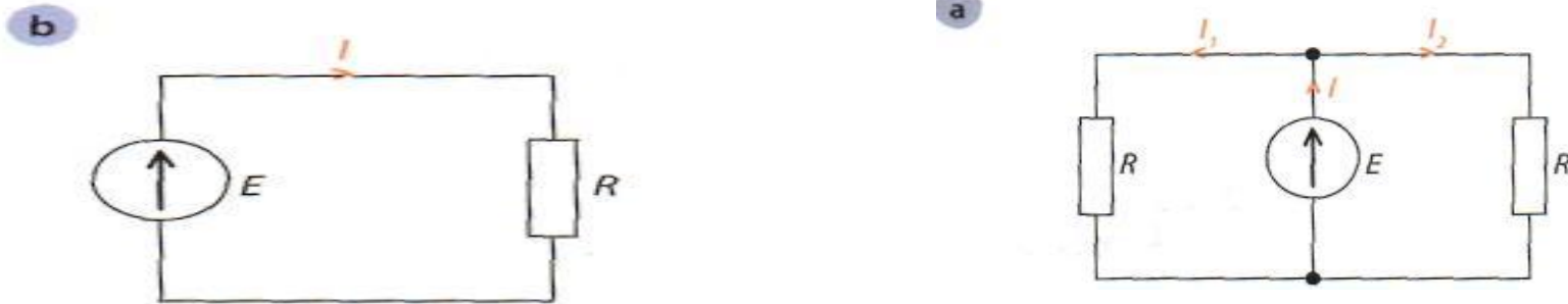
Rys. 2.9. Rodzaje obwodów: a- rozgałęziony, b- nierozgałęziony
