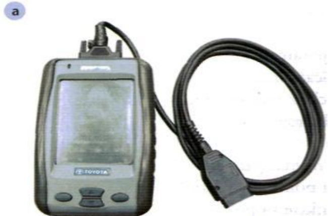
Rys. 4.25. Testery systemu diagnostyki pokładowej OBD: a- tester OBD firmy Toyota, b-tester OBD zintegrowany z komputerem firmy Panasonic
