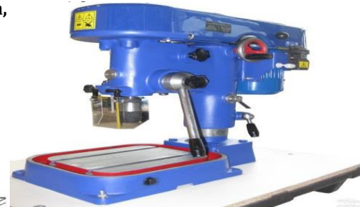
Rys. nr 7.26. Wiertarka stołowa 1 – silnik elektryczny, 2 – wrzeciono, 3 – korpus, 4 – podstawa, 5 – słup, 6 – dźwignia,
