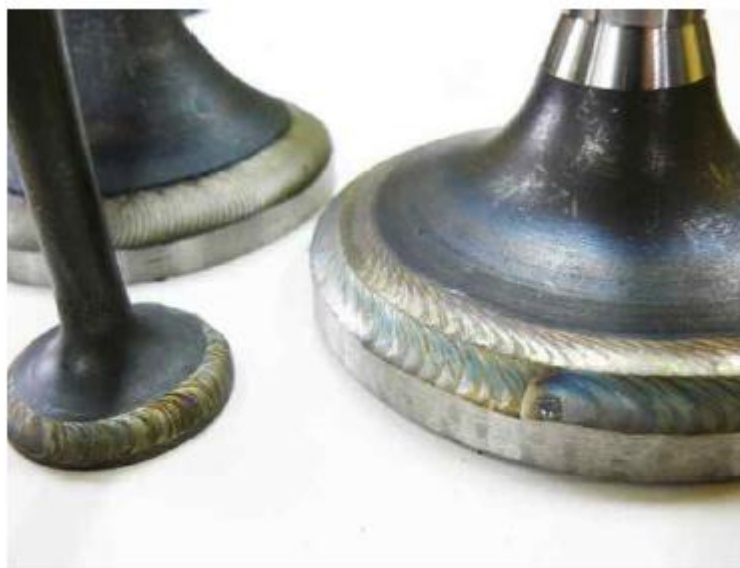
Rys. 4.6. Przykłady napawanych krawędzi zaworów
