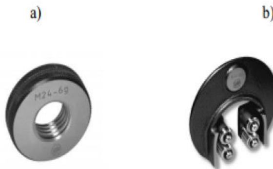
Rys. 3.26. Sprawdziany do gwintów zewnętrznych: a) pierścieniowy, b) szczękowy rolkowy
