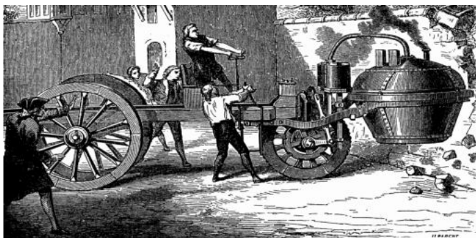
Rys. 0.2. Pojazd parowy używany do transportu dział, zbudowany przez Francuza Cugnota w 1759 roku; w czasie swojej pierwszej jazdy uderza w mur i łamie się [21]
