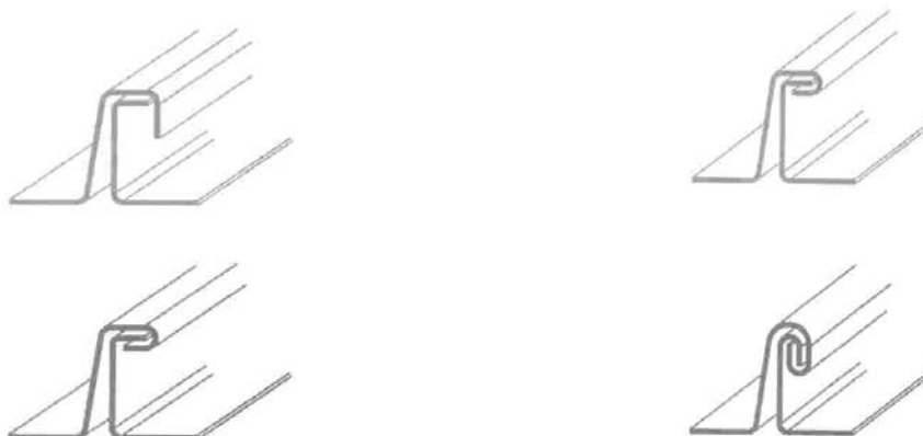
Rys. 67. Etapy zaginania rąbka stojącego pojedynczego - kąowego [opracowanie własne]
